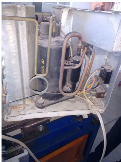
Figura 11. Vista interna de la unidad de ventana
